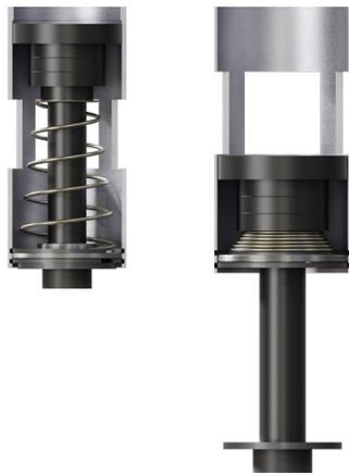
◀ Sistema di pulizia semi-automatico con pistone pneu-meccanico
