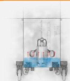
**1** Il liquido viene aspirato, mentre il galleggiante attiva la pompa. **La turbina continua ad aspirare.**
